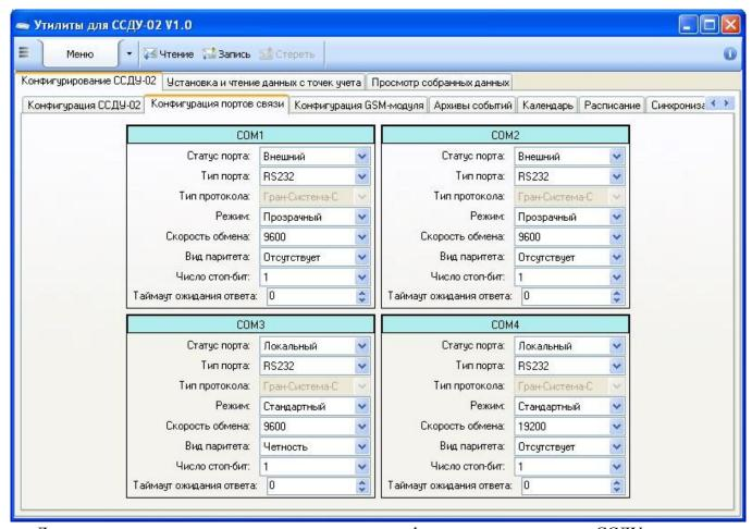
Данная вкладка предназначена для изменения конфигурации портов связи ССДУ.
