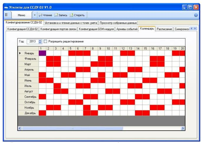
Данная вкладка предназначена для чтения и модификации календаря выходных дней ССДУ.
