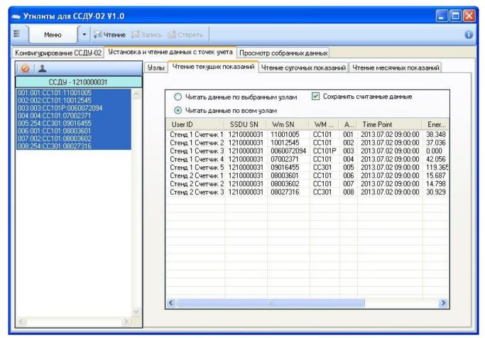
Данная вкладка позволяет прочитать последние показания накопленной энергии, считанные со счетчиков.
